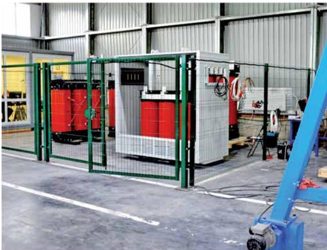
Каждый трансформатор проходит заводские приемосдаточные испытания для абсолютной уверенности в его качестве и соответствии заявленным характеристикам. Испытания регулируются и проводятся согласно государственно-го стандарта ГОСТ Р 54827-2011 (МЭК 60076-11:2004)
