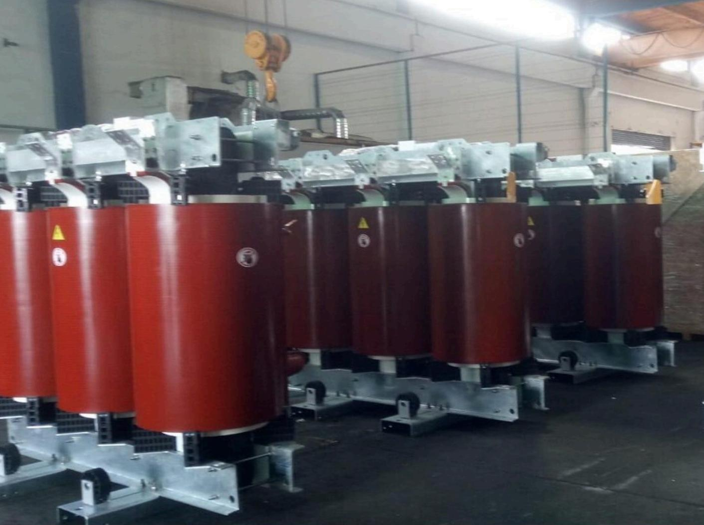
**Сухие трансформаторы** с литой изоляцией типа ТСЛ, ТСЗЛ производства **ООО "СВЕРДЛОВЭЛЕКТРОЩИТ"** могут заменять: масляные трансформаторы
