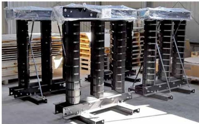
**МАГНИТОПРОВОД** - часть конструкции трансформатора, предназначенная для прохождения магнитного потока, возбуждаемого протекающим в первичной обмотке электрическим током. Материал магнитопровода - кремнистая электротехническая сталь. Стержни и ярма магнитопроводов в трансформаторах соединены между собой по методу «Step-Lap», что улучшает прохождение магнитного потока, снижает ток холостого хода и шум. Данный метод обеспечивает повышенную механическую прочность магнитной системы.
