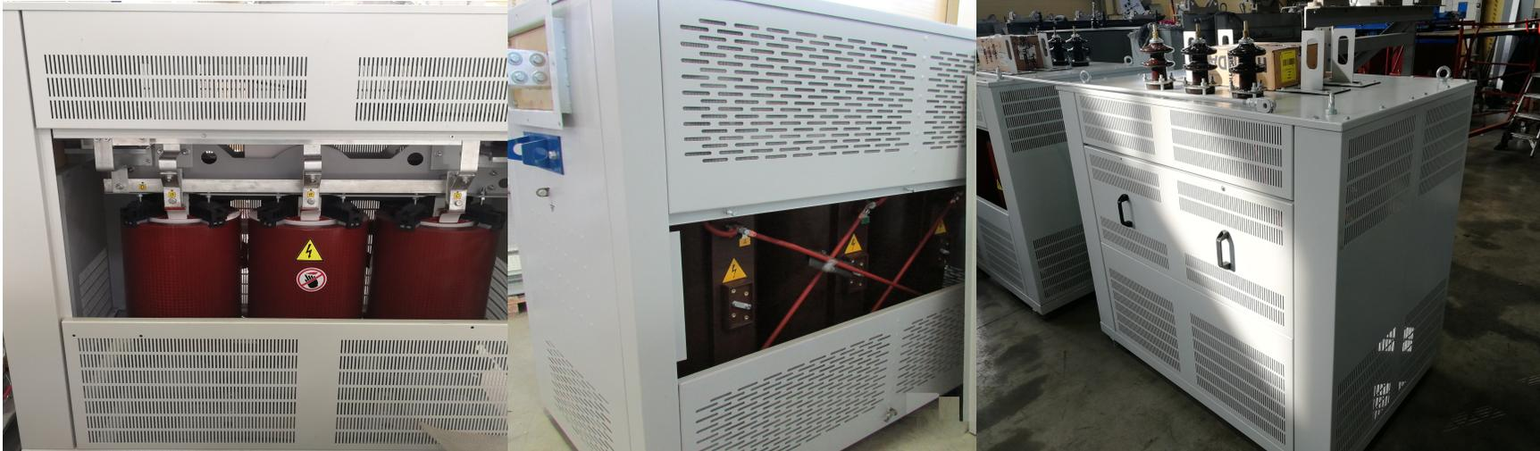
**ЗАЩИТНЫЙ КОЖУХ** - предназначен для защиты трансформатора от внешних воздействий и представляет собой металлическую конструкцию. Для циркуляции воздуха в верхних и нижних частях кожуха предусмотрены вентиляционные отверстия. Трансформаторы могут быть изготовлены в варианте ТСЛ (без защитного кожуха, Ip00) и ТСЗЛ (в защитном металлическом кожухе):
